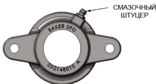
Рисунок 4 Расположение смазочного фитинга на крышках подшипников
